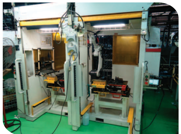
Desenvolvemos sistema customizado da célula de segurança exigido pelo Ministério do Trabalho (NR-12)
